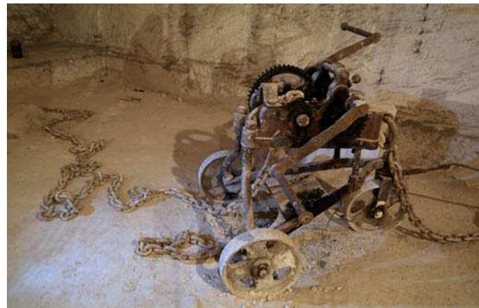
Crapaud permettant de tirer les blocs à l'aide de chaines
