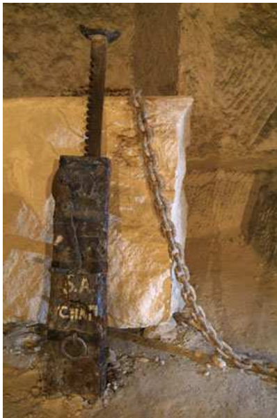
Criqua permettant de soulever les blocs
