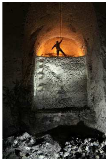
Front de taille en gradins droits (carrière de Louvecienne)
