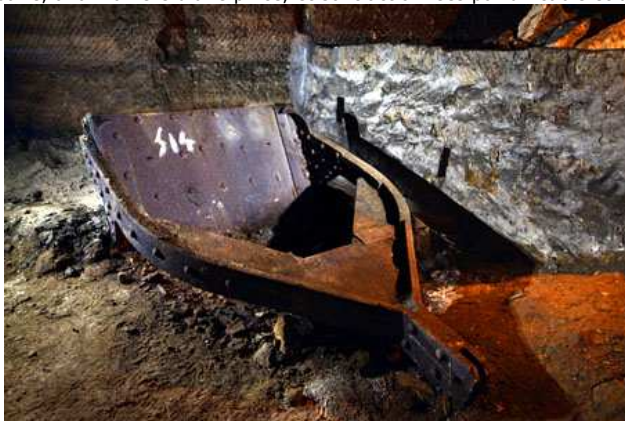
Raclette qui fonctionne par paires à la façon d'une pince (Port -Maron)
