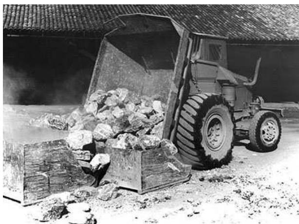
Chargeur automoteur à la sortie d'une carrière de gypse (source: base Mérimé)
