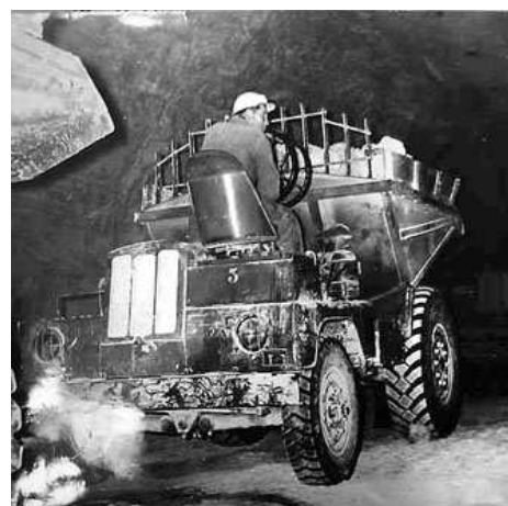
Chargeur amphidrome (source: Derelicta, coll. M.Pécé)
