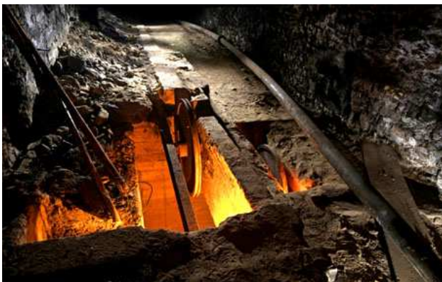
Treuil de la galerie inférieure, destiné au gypse tendre
