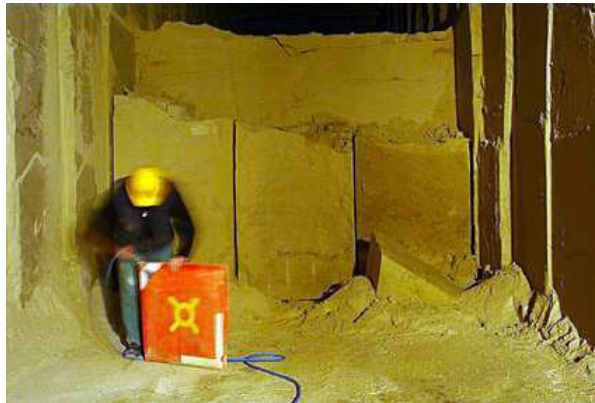
Préparation d'un coussinet (photo: Tchorski)
