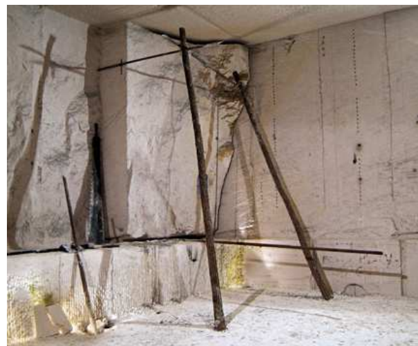
Lance de carrier et son support - vue de côté (Carrière D'Aubigny)
