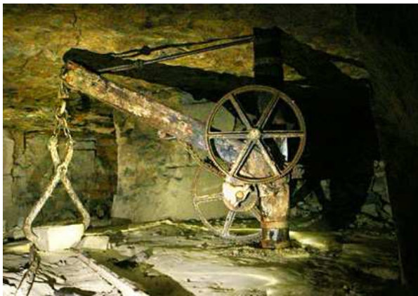
Grue manuelle en bois avec démultiplication (Carrière de Volvic)
