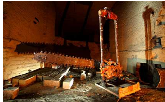
Reste de Haveuse verticale abandonnée (Méry-sur-Oise)
