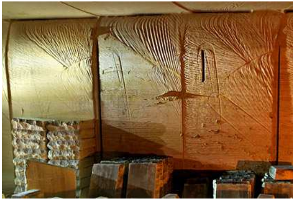
Traces en éventail d'une haveuse verticale (Triel)
