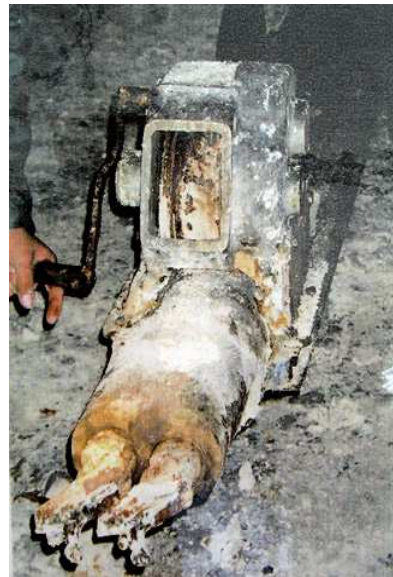
Reste du moteur d'une haveuse à double fleurets
