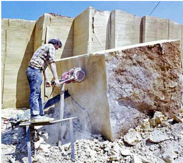
Découpage d'un bloc avec une haveuse à mains
