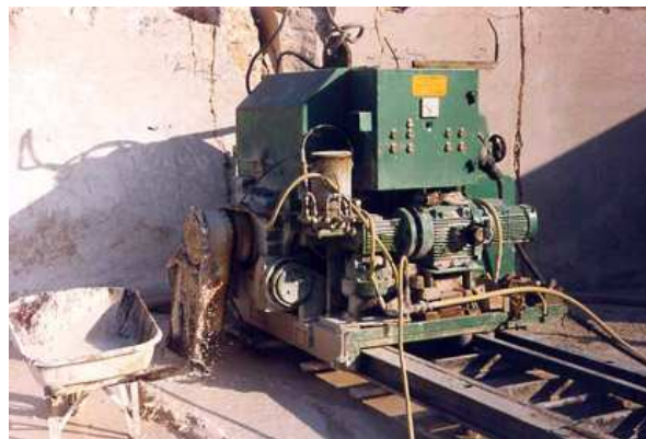
Haveuse sur rail, dans une carrière à ciel ouvert
