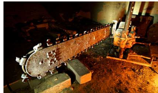
Lame de haveuse verticale (Méry)
