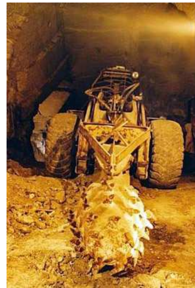
Véhicule avec bras mobile à fraise
