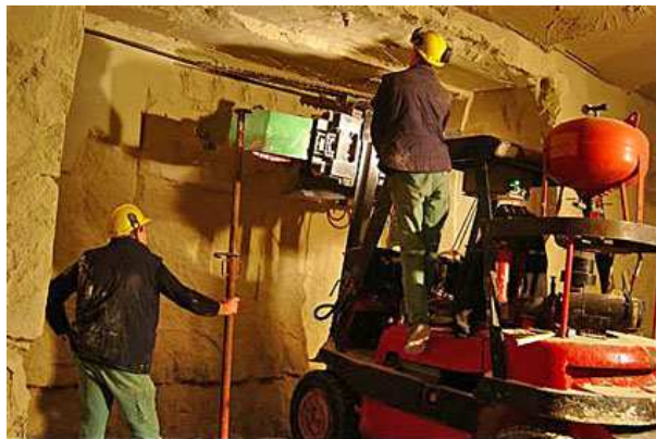
Souchevage avec haveuse sur manitou (photo Tchorski)
